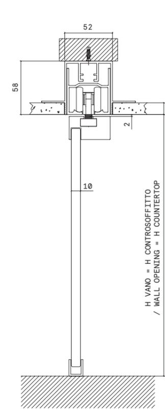
**BINARIO SINGOLO FISSAGGIO A SOFFITTO CON CONTROSOFFITTO**
