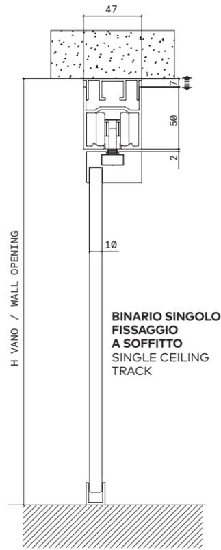
**BINARIO SINGOLO FISSAGGIO A SOFFITTO**
