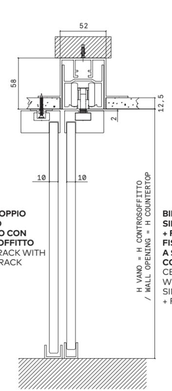
**BINARIO SINGOLO + FISSO FISSAGGIO A SOFFITTO CON CONTROSOFFITTO**
